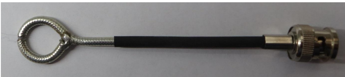
H-Feld Sonde mit 15 mm Durchmesser -Selbstbau-
