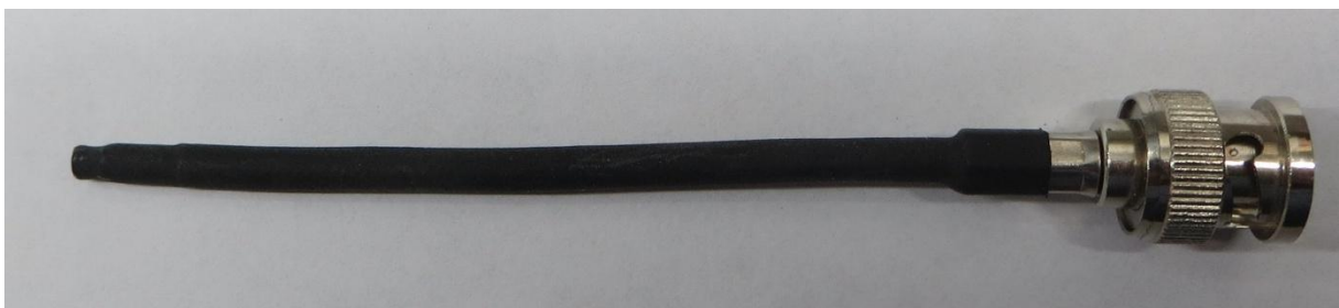
E-Feld Sonde 5 mm -Selbstbau-
