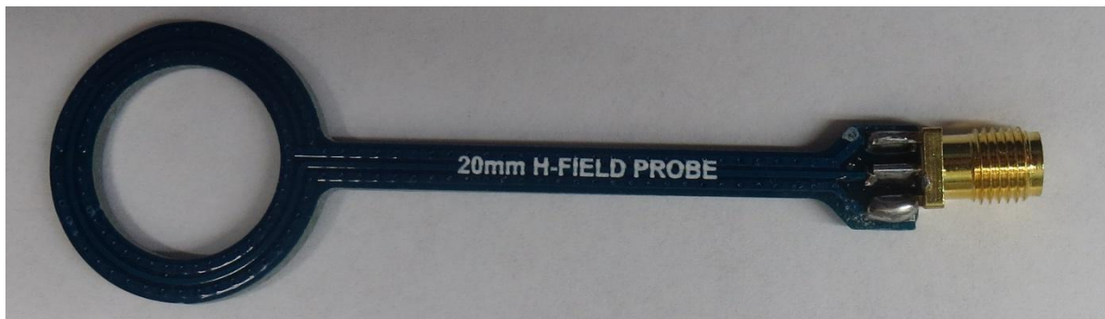
H-Feld Sonde mit 20 mm Durchmesser -zugekauft-
