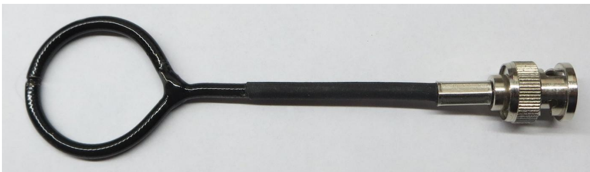
H-Feld Sonde mit 30 mm Durchmesser -Selbstbau-
