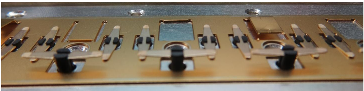
Detailaufnahme Kontaktfedern, vorne ausgefahren > Kontakt, dahinter eingefahren > offen
