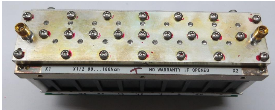
Eichleitung von unten, hinter der Platte liegen die Dämpfungsglieder
