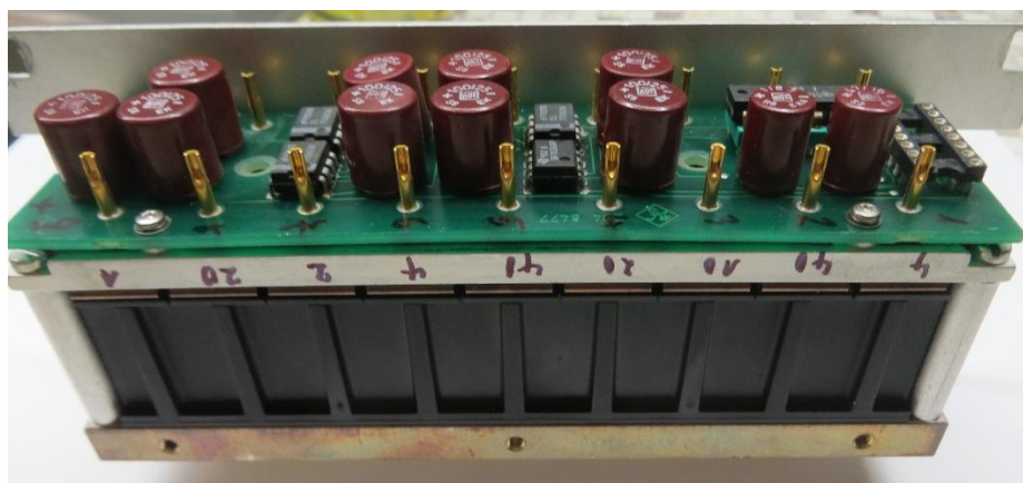
Eichleitung mit Ansteuerung, gut erkennbar die 100 \mu F Kondensatoren
