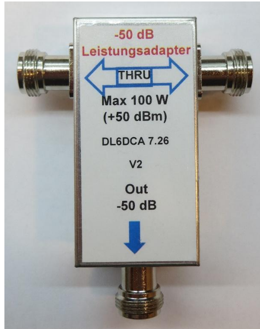
Bild 1: realisierter -51 dB Leistungsadapter
