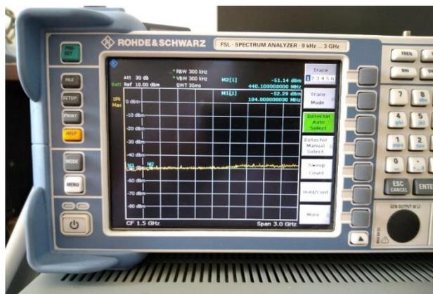
Das folgende Bild zeigt die Ergebnisse direkt am Ende der Antennenleitung, vor allen Filtern.
