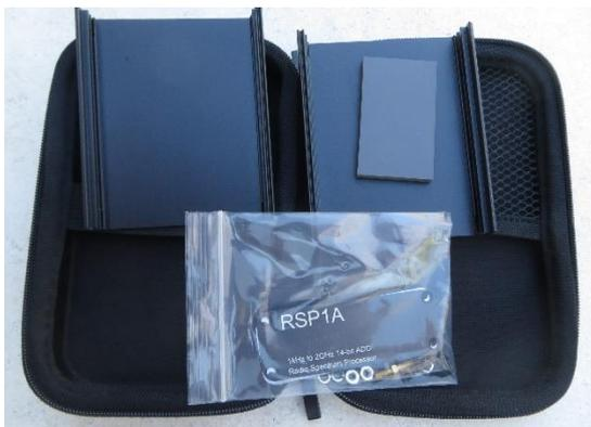
Es besteht aus zwei Alu-Halbschalen mit vorbereiteter Vorder- und Rückfront, den zugehörigen Schrauben und einer gut verarbeiteten Hardcase Tasche. Das Aluminiumgehäuse ist schwarz mit Pulverlack beschichtet. Insgesamt sehr sauber verarbeitet.
