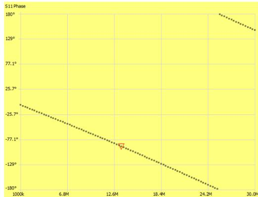
Kabel geschlossen = Ermittlung Induktivität des Kabels
