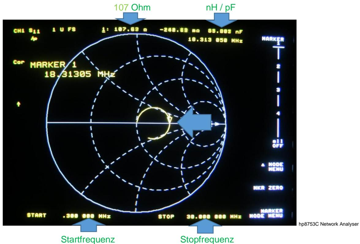
Der Marker wird nun auf der Nulllinie des Smith Diagramms (horiz. Pfeil) so positioniert, dass er auf der Kippe induktiver Teil (nH) / kapazitiver Teil (pF) gerade den kapazitiven Bereich erreicht. Letzteres ist in der obigen Messwertzeile (rechter Pfeil) zu sehen.
