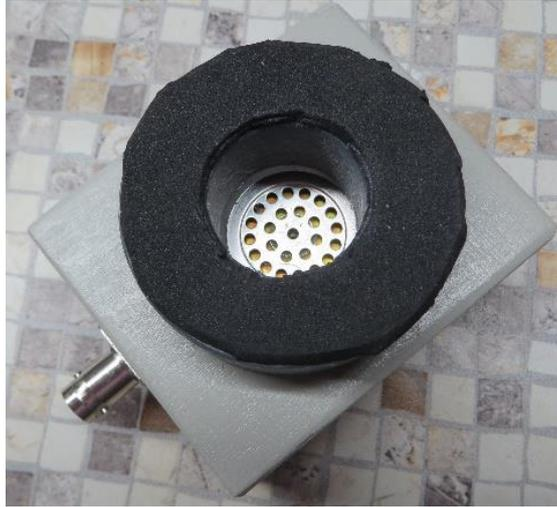
Im Rahmen der Vermessung von Funkgeräten an einem Funkmessplatz ist es z.B. zur Ermittlung des Hubes erforderlich, dem Mikrofoneingang ein 1 kHz Signal vom Messgerät kommend zuzuführen. Je nach Hersteller gibt es zahlreiche Arten von Mikrofonbuchsen. Selbst bei mechanisch gleicher Ausführung ist dann noch auf die Pin-Belegung zu achten. Wenn dann auch noch eine Hilfsspannung an einem der Kontakte anliegt, wird es gefährlich mit provisorischen Verbindungen.
