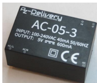
Kleinstschaltnetzteil, nur 36 x 24 x 17 mm groß
