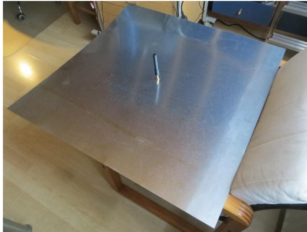
„Antennenmeßfeld“ Metallplatte 75 / 75 cm mit Antenne
