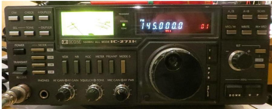
Der clubeigene 2m Allmode-Transceiver IC271H sollte normalerweise mit 100W senden. Leider kamen aber nur noch ca. 20 W aus dem Antennenanschluss.
