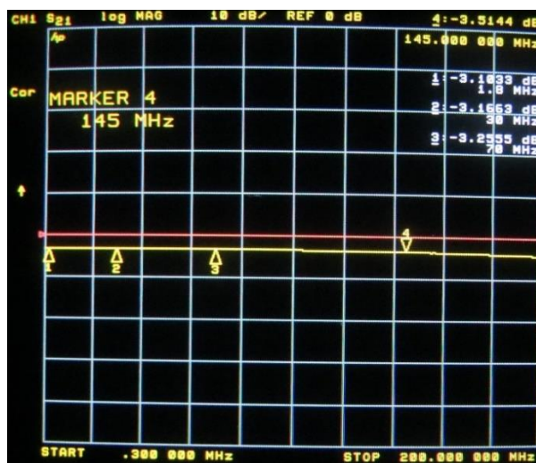
S21 Durchgangsdämpfung zwischen Port A und B/C
