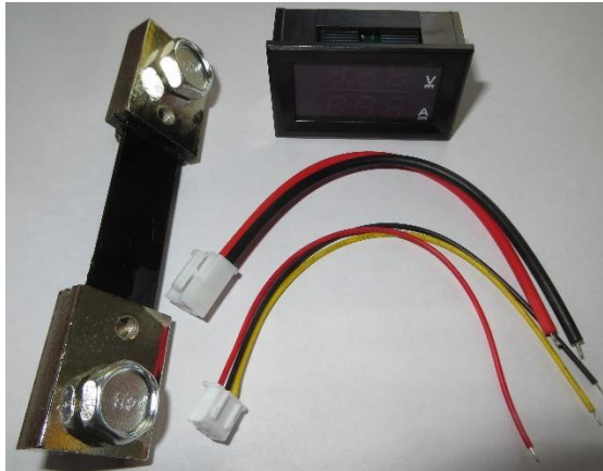
Messmodul mit Shunt und Verbindungskabeln
