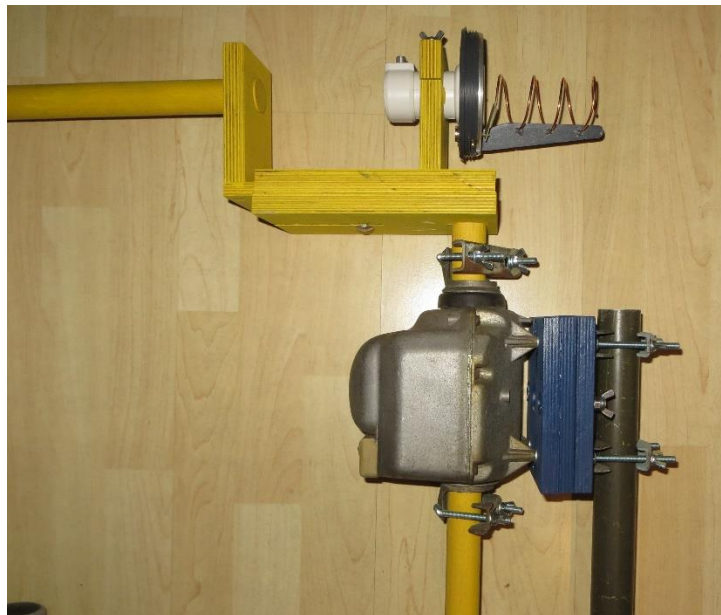
Rotor Azimuth um Mittelpunkt Achse drehend z.B. zur Bestimmung Öffnungswinkel Helix
