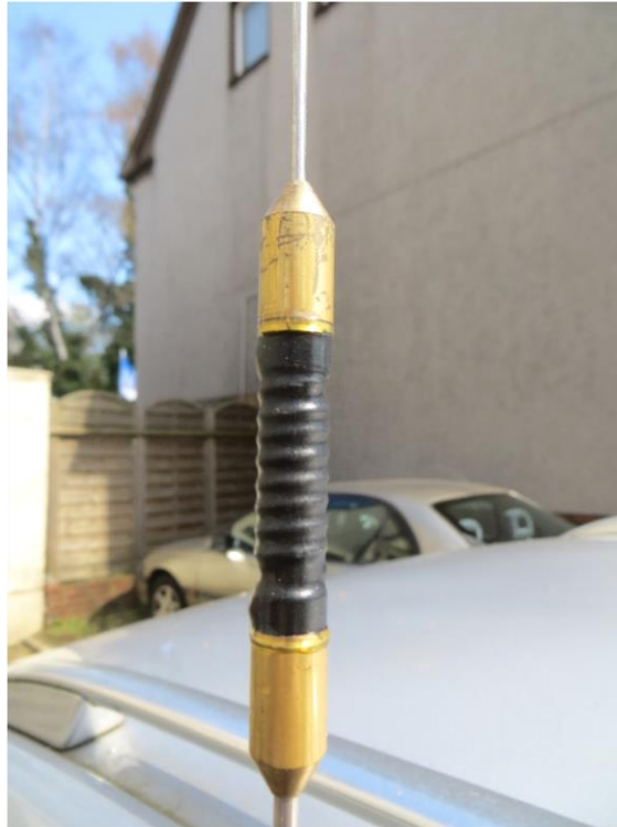
Mittige Verlängerungsspule 2m / Umwegleitung für 70cm
