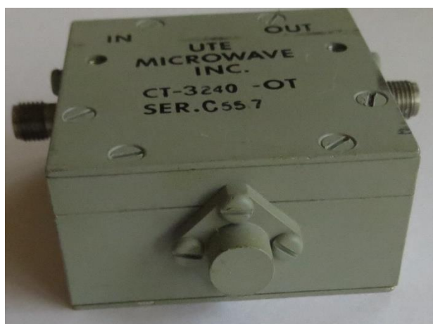
Mittig 50Ω Abschluss, deshalb Isolator
