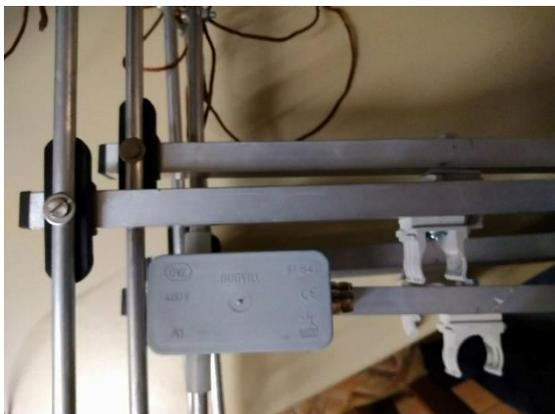
Befestigung für Elemente und Trage-Mast
