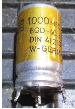
Defekter Kondensator C65 1000 \mu F 40V
