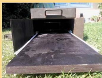
**Bild 2:** Relaiskiste mit Schublade und Akkuhalterung im Hintergrund
