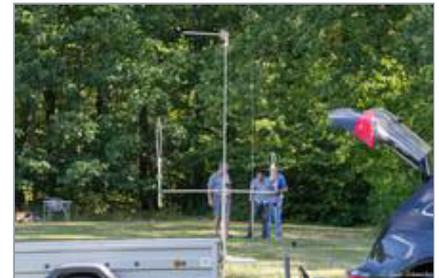
Helmut hat ein Setup für LEO-Satelliten aufgebaut: Erprobung von jeweils einer Eggbeater-Antenne (Rundstrahlantenne mit erweitertem Elevationsdiagramm) im 70cm und 2m-Amateurband zum Empfang von tieffliegenden HAM-LEO´s in Höhen von 200 bis 2000km. Satelliten im Low Earth Orbit werden in der Regel für Kommunikationszwecke, militärische Aufklärung, Spionage und andere bildgebende Anwendungen eingesetzt. Empfangen wurde mit einem SDR-Stick und visualisiert mit der SDR-Console V3.
