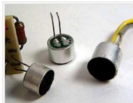
Elektretmikrofonkapseln: preiswert, kompakt und robust
