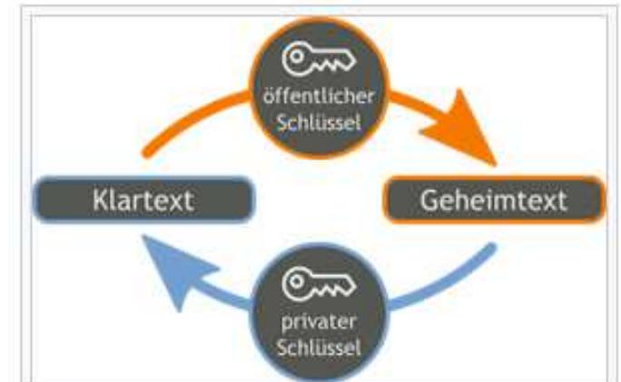
Bei der asymmetrischen Verschlüsselung gibt es zwei unterschiedliche Schlüssel, den öffentlichen Schlüssel zur Verschlüsselung und den privaten Schlüssel zur Entschlüsselung
