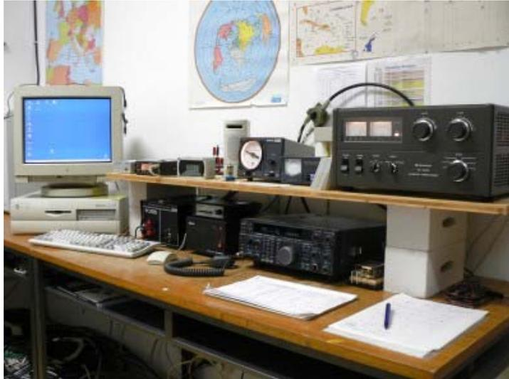
Die Kurzwellenstation besteht aus einem KENWOOD TS-850SAT mit einer Endstufe KENWOOD TL-922. Bei den Antennen handelt es sich um einen SOMMER XP707 (DJ2UT-Beam) sowie einem Dipol für 160m/80m/40m.
