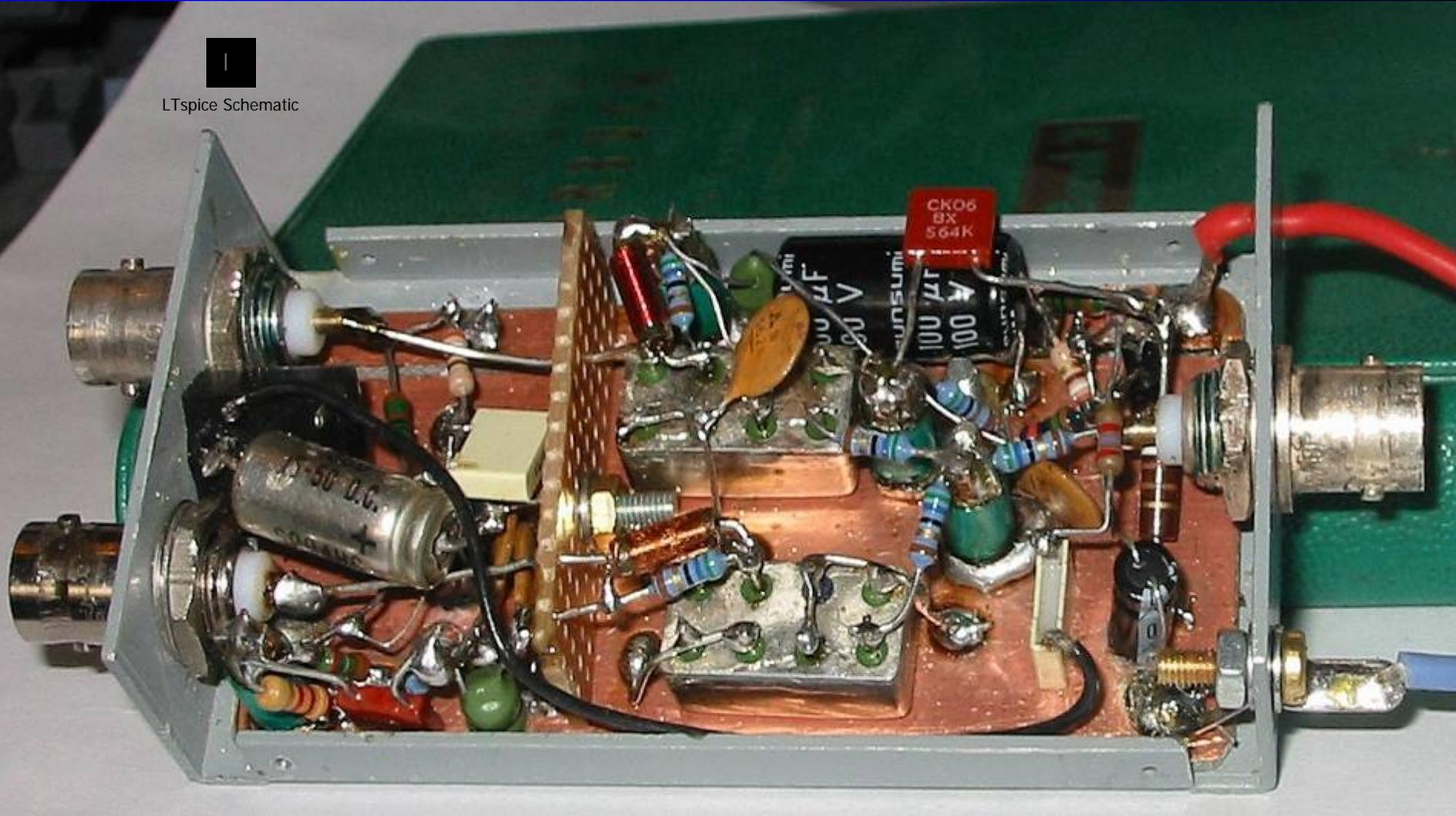
Empfänger: *Der Direkt-Umsetzempfänger mit I/Q Mischer*
