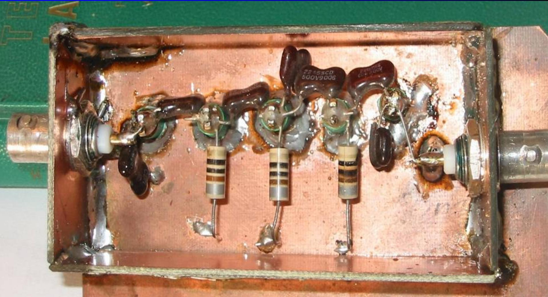
Empfänger: *Der Direkt-Umsetzempfänger mit I/Q Mischer*
