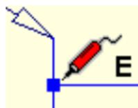
auf Knoten wird der Mauszeiger zum Probe-Symbol, Klicken plottet Spannung im Diagramm
