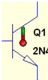
mit gedrückter Alt-Taste wird der Mauszeiger über Bauteilen zum Thermometer, Klicken plottet (Momentan-)Leistung
