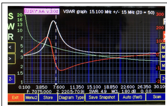
Bild 1 vor Modifikation grüne Kurve SWR
