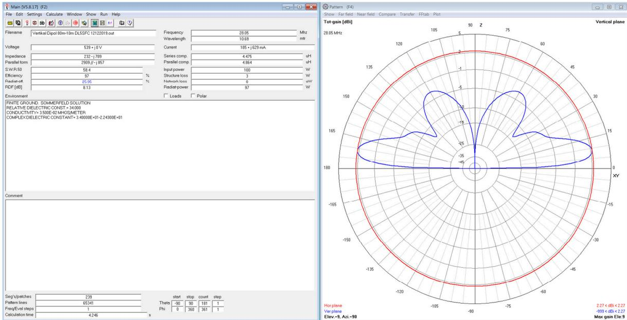
Alle Drhte 6,34m lang 2mm Antennenlitze. Winkel zwischen den beiden Schenkeln 76°
