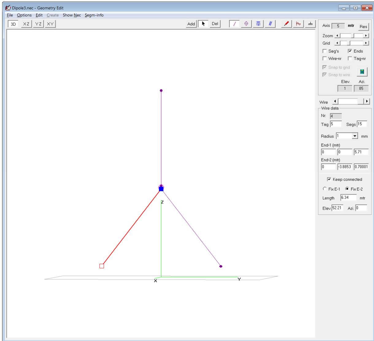
Vergleichsantenne: vertikaler Dipol 2x6,34m auf 13,7m Masten.
