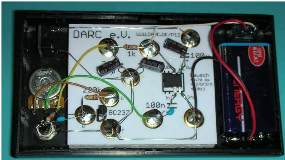
Das Brettchen wird mit Teppich-Klebeband in ein aus zwei Halbschalen bestehendes Gehäuse mit Schnappverschluss eingebaut. Die beiden Buchsen, das Poti und der Schalter werden in dieses Gehäuse eingebaut. Das Brettchen sorgt dafür, dass die Batterie an ihrem Platz bleibt.
