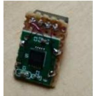
**Anschluss** | Der Anschluss des Moduls an einen AVR ist sehr einfach. Zwei Pins des Moduls dienen der Stromversorgung (der Sensor mag lt. Datenblatt alles zwischen 2.7 und 5.25 V), die anderen beiden Pins sind SDA und SCL und werden dementsprechend direkt mit dem  $\mu$ C verbunden. Die I2C-Adresse des Moduls ist H30.
