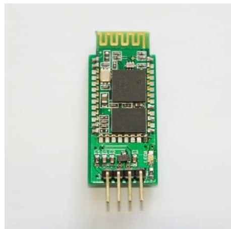
Das Modul wird wie eine serielle Schnittstelle angesprochen. Sendet ein Handy eine Buchstabenfolge, so wird diese mit folgendem Programm auf dem seriellen Monitor angezeigt:
