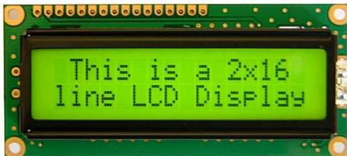
Auf das Roby III kann ein LCD-Display Typ 16x2 direkt aufgesteckt werden
