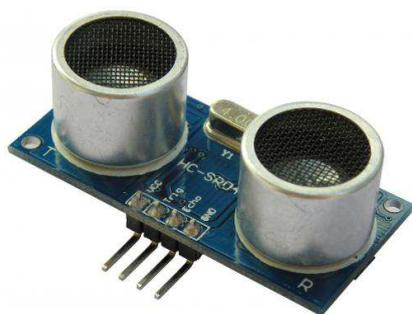
Verwendung finden kann der Ultraschall-Distanz-Sensor HC-SR04. Das Modul kann direkt aufgesteckt oder über ein 4-ploiges Verbindungskabel angeschlossen werden. Funktion des Moduls:
