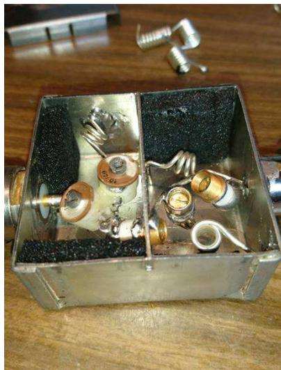
(Tiefpass, elliptisch 6. Ordnung, - 54dB Dämpfung auf 70cm, Verluste auf 2m nur -0,05dB).
