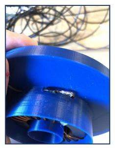
Neben diesem Loch finden sich zwei weitere, die als Zugentlastung für die Lötverbindung zwischen dem Draht des Transformers und dem Antennendraht dienen. Es empfiehlt sich, den Antennendraht durch die Löcher zu fädeln bevor man den Transformer einsetzt.
