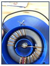
Alle wesentlichen Teile der Antenne finden sich im Hauptteil. Die Drähte durch die kleinen Löcher zu fädeln erfordert etwas Geduld. Vor allem wenn man etwas dickere Kupferdrähte verwendet, wie hier. Die Schraube, die man auf dem Bild rechts in der Mitte sieht, hält in meinem Falle den Knopf zum Festhalten beim Kurbeln.
