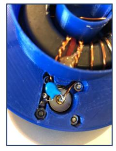
Auf dem unteren Bild sieht man den Kondensator. In der aktuellen Version des Drucks hat dieser etwas mehr Platz.
