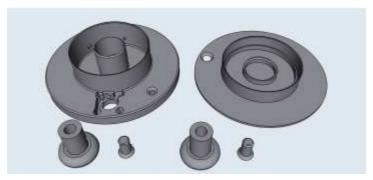
Hauptteil, Deckel, Knopf zum Halten beim Aufwickeln, Bolzen zur Befestigung des Knopfes, Knopf zum Kurbeln, Bolzen für die Kurbel (von oben links nach unten rechts)
