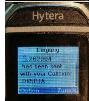
Über das POCSAG-Gateway können Nachrichten an einen POCSAG-Pager (z.B. Skyper o.Ä.) aus dem DMR-Netz gesendet werden.
