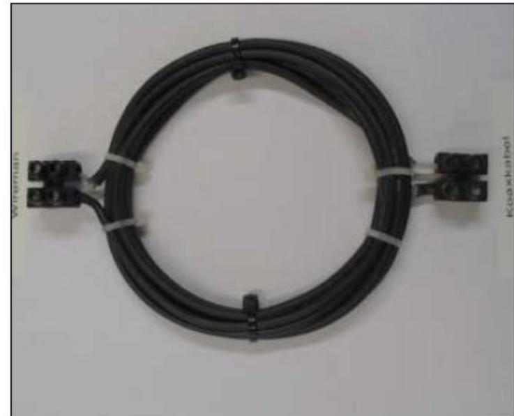
Bild 11: Koaxialkabelbalun; die Kompensationswicklung besteht hier aus 4-mm<sup>2</sup>-Rangierdraht.
