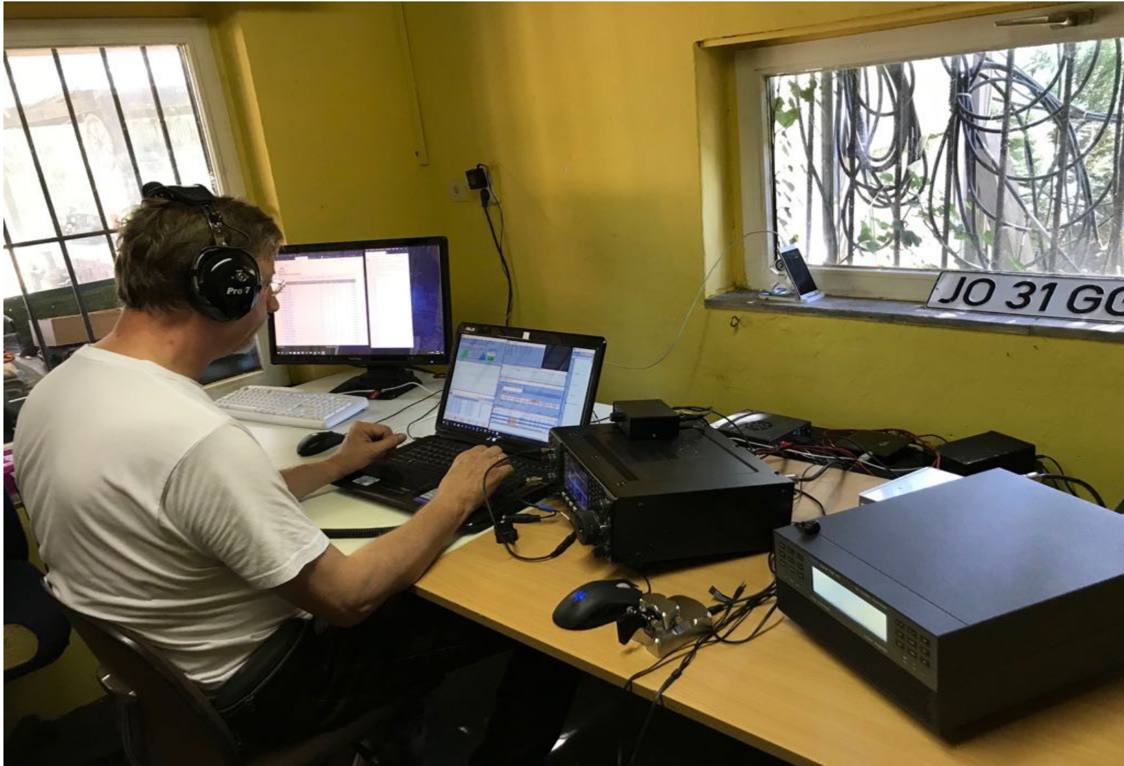
DF0RW – Aufbau mit minimal Ausstattung. TRX IC7600, PA Expert 1k3 schaltet bei Bandwechsel vier Antennen automatisch.
