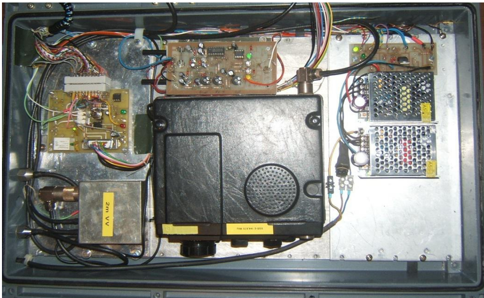
Transponder 2 m - 70 cm 2m Vorverstärker, dahinter diese Platine dient der Spannungsanpassung zwischen Rechner und Sender. In der Mitte, SSB - Empfänger, dahinter die SSB - Rauschsperrre und rechts die Netzteile. Alles eingebaut In einer Gehäusehalbschale. (ehemals ein Stornofunkgerät) Transponder 2 m - 70 cm SSB Rauchsperrre
