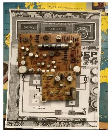
Das Besondere daran: mittels elektro-mechanischem 500 kHz-Filter und zweier Ringmischer, mal als Modulator und mal als Demodulator eingesetzt, wurden die ZF- und die NF-Stufe mit analogen integrierten Schaltkreisen sowohl im RX als auch im TX genutzt.
