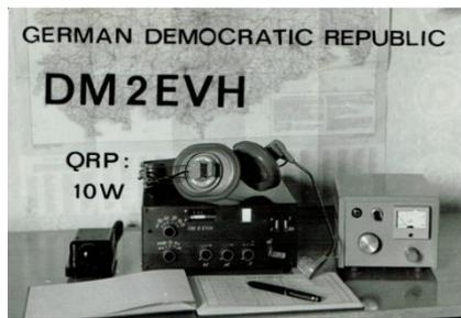
Ein leuchtendes Beispiel dafür ist wohl der „SSB/CW All-Band Portable-Transceiver nach dem Direktmischprinzip“ mit Dioden-Ringmischer, den er noch als DM2EVH aufgebaut hat. Seine Darstellung des QRP-TRX im FUNKAMATEUR Heft 10/1979 ruft bei mir heute noch eine „Gänsehaut“ hervor:
