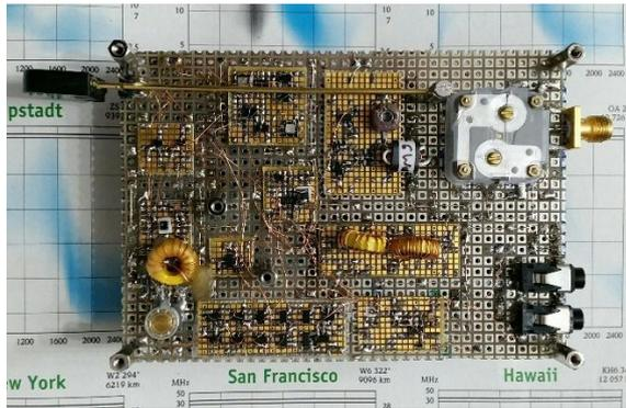
Mit der vorhandenen PA, die mit 1,5 V betrieben wird, ergibt sich eine Ausgangsleistung von etwa 0,3 W. Eine elektronische Morsetaste ist fester Bestandteil des 1V-TRX. Wegen der Batteriespeisung gibt es keine Masse-Probleme oder Frequenzverwerfungen beim Handling der noch uneingehausten Platine.
