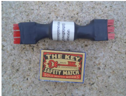
Bild 15 kompakter Verteiler mit 1 Eingang + 5 Ausgängen
