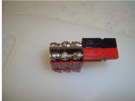
Bild 21 DJ9OZ-Block vor dem Isolieren mit Heißkleber
