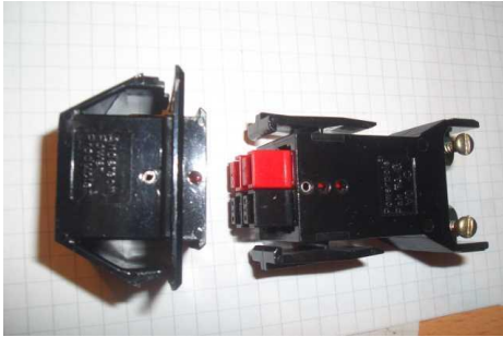
Bild 13 Halterung + Stecker für 4-pol. Kontaktblock von oben
