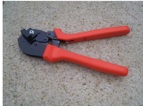
Bild 2 +3 Krimpzange für 3 Kontaktgrößen 15A, 30A, 45 A
