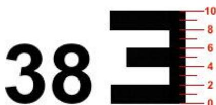
Die Angaben sind, in den meisten Fällen, als Dezimal-Darstellung angebracht. Im Beispiel bedeutet die 38 einen Pegel von 380 cm. Das E-Symbol, egal ob nach rechts oder links weisend, ist eine Ablesehilfe für die nächsten 10 cm, hier rot eingefügt. Die offene Seite des Symbols zeigt immer zur dazugehörigen Dezimeter-Marke.
