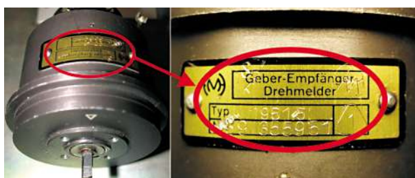
Bild 2: Ein Drehmelder-Sender/Empfänger aus DDR-Produktion, wie wir ihn suchen
