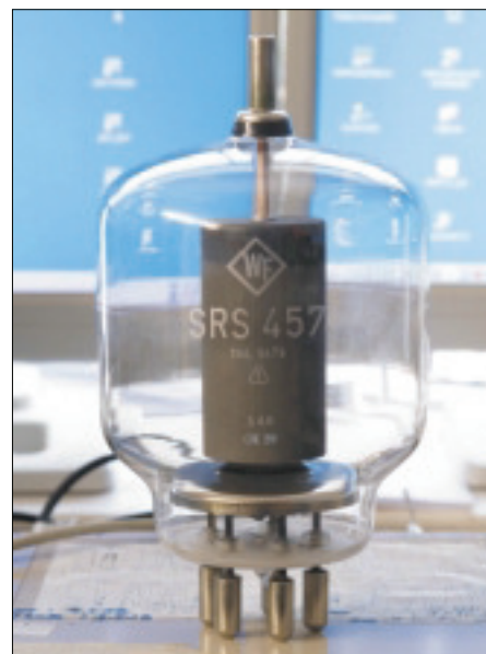
Die in der Endstufe verwendete Röhre SRS457 ist eine luftgekühlte Tetrode.
