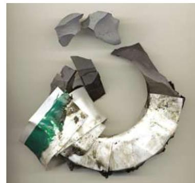
**Bild 1:** Dieser Ferritring setzte die 750 W in Wärme um – und explodierte
