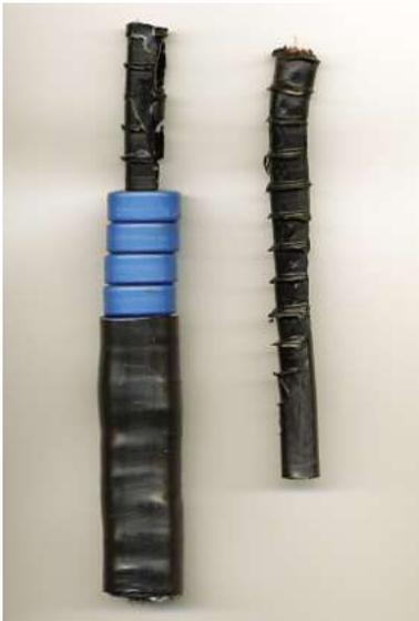
**Bild 2:** Unter den Ferritringen dieser Mantelwellensperre wurde es so heiß, dass es zwischen Innen- und Außenleiter des Koaxkabels zum Kurzschluss kam
