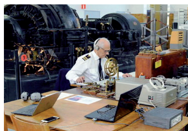
Zum Alexanderson-Tag wieder aktiv: der Maschinensender SAQ im schwedischen Grimeton auf 17,2 kHz
