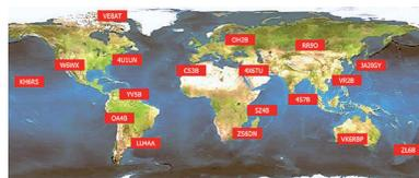
Jede der 18 um den Globus verteilten Baken sendet je einmal in drei Minuten auf fünf Bändern und das rund um die Uhr. Sendefrequenzen (kHz) sind: 14 100, 18 110, 21 150, 24 930 und 28 200.
