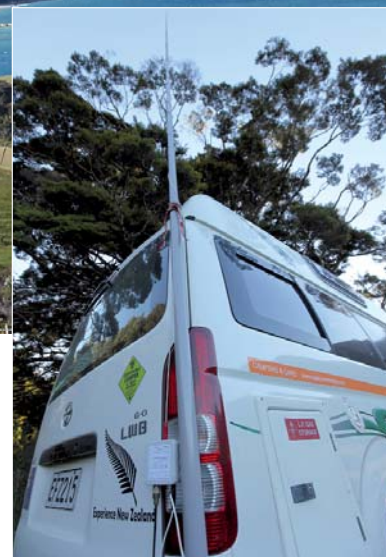
9,6 m Draht an einem GFK-Mast genügen für Kontakte mit Frankreich, Ungarn, Chile, Japan und Australien
