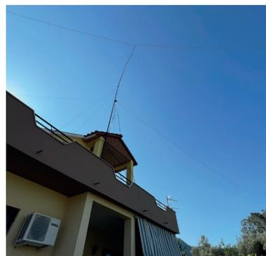
Bild 1: Schiebemast mit Dipol und Triple-Leg
