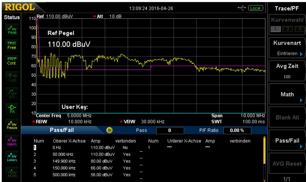
Asymmetrisch (Common Mode), Antennenanschluss mit Erde verbunden
