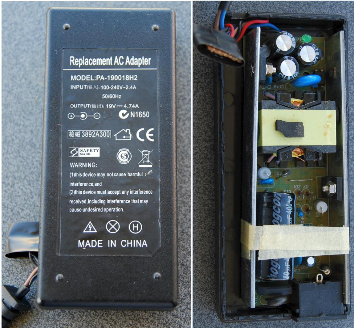
Sperrwandler mit einem Fairchild FAN7554 PWM Controller IC und MOSFET. Kein Netzfilter, Kein Snubber über den Sekundärgleichrichter. Mit billigem Kreppband behelfsmäßig zusammengehaltene Kühlbleche. Mit Isolierband umklebte Zusatzbauteile auf Lochrasterplatte.
