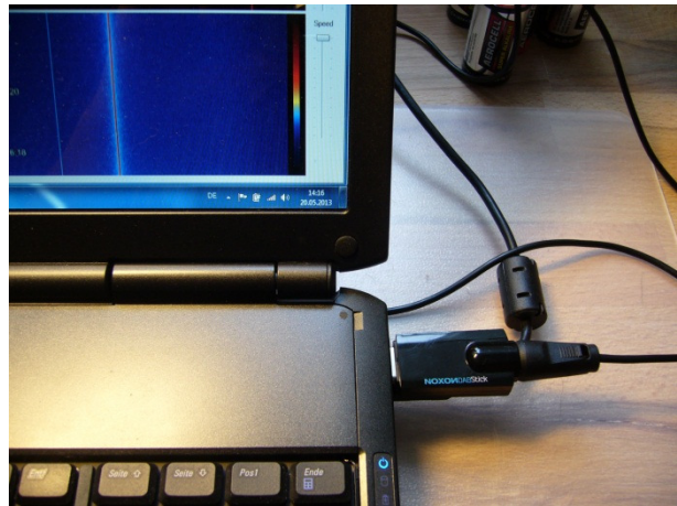
Abbildung 5: DAB-Stick als Funkempfänger
