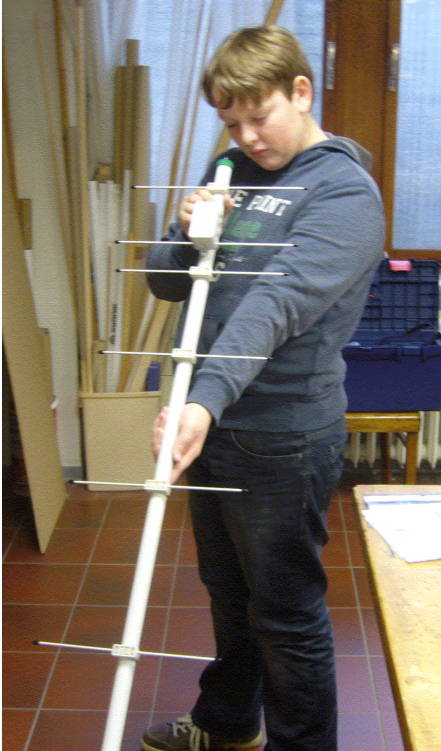
Abbildung 6: Die parallele Ausrichtung der Antennenelemente wird geprüft
